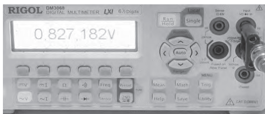
写真2 高級なデジタル・マルチメータは表示桁数が多い それだけ確度が高いのだが、使い方が悪いと正確さは損なわれる
