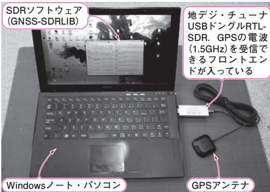
写真1 地デジ・チューナUSB Dongleとソフトウェアで作るUSB Dongle GPSナビ
