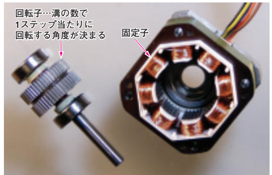
写真1 ステッピング・モータ KP42HM2-502 を分解したようす (HB型, 日本サーボ)
