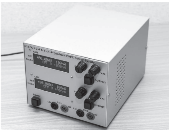
写真1 出力±15V & ±400mAの実験用に万能な定電圧・定電流(CVCC)電源を製作した4象限動作。正負の電源にも電子負荷にもなる
