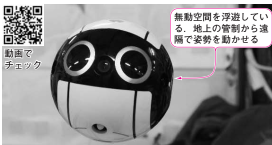
写真3 国際宇宙ステーションの中で浮遊するドローン「Int-Ball」(©JAXA)
