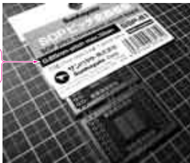
写真3 表面実装マイコンをユニバーサル基板に乗せられるようになる「SOPピッチ変換基板」 SSP-61 (0.65mmピッチ, 最大32ピン用), サンハヤト( http://www.sunhayato.co.jp ), 924円
