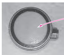
(b) 垂直探触子の例 (中心周波数5MHz, 振動子径φ20mm)
