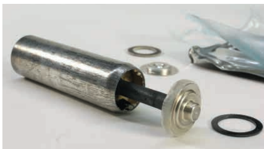
(b) 炭素棒(正極)を引き抜く
