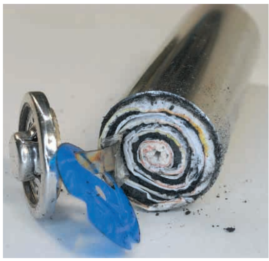
(a) 外装ラベルをはがし、正極端子を外したところ
