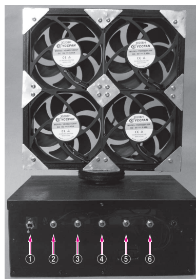
写真1 首振り機構付き4連扇風機
