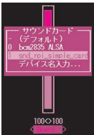
図2 alsamixerコマンドを入力してボリュームを有効にする AlsaMixerの画面。デバイスを選択して音量を調整する
