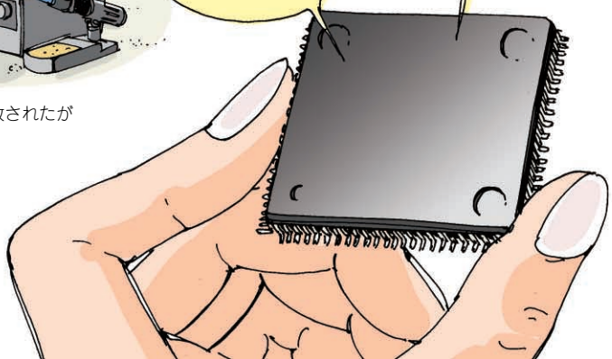
図7 はんだごてからの解放、回路動作の高速化やCPUのような可変性は、FPGAという一つの小さなLSIで実現できる
