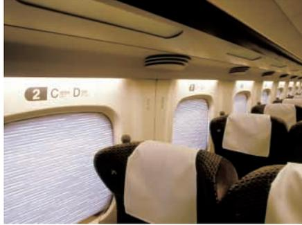
写真5 窓際上部に設置されたLED側補助灯
