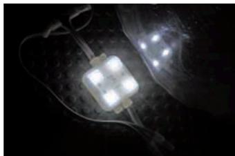
写真11 使用されているLEDモジュール
