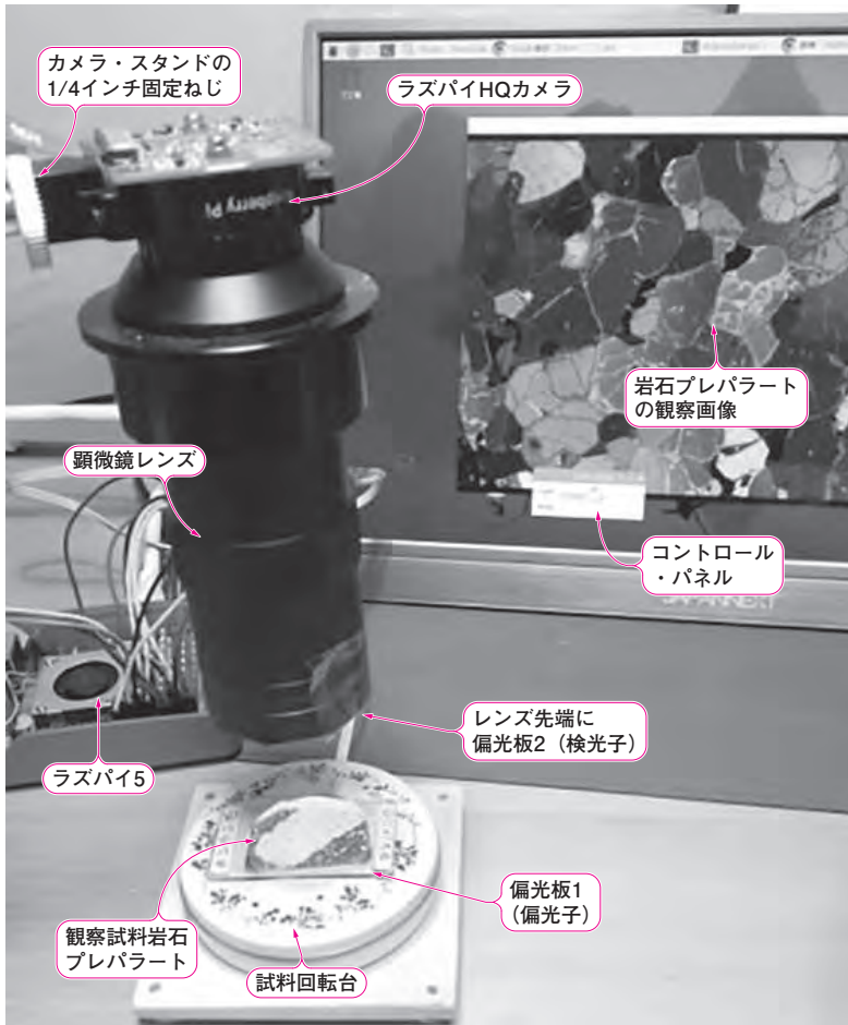
写真1 製作したラズパイ顕微鏡カメラ・システムの全体像 偏光板をクロスニコル構成にした偏光顕微鏡カメラ・システムを用いて、岩石プレパラートの鉱物組織画像を取得している実験のようす。モニターに表示される画像を見ながら顕微鏡レンズの調整を行い、観察位置が決まったらコントロール・パネルの [Capture] ボタンを押して画像の取り込みを行う
