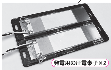
(b) 発電靴…各2枚の圧電素子が靴底に配置されている
