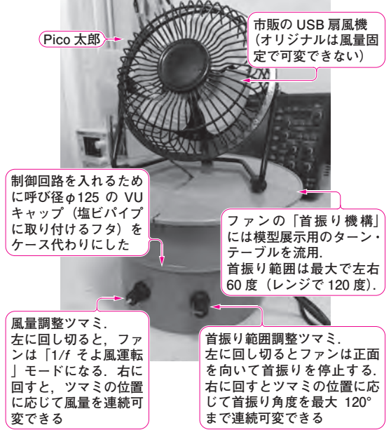
写真2 製作したそよ風USB扇風機「Pico太郎」 市販のUSB扇風機に1/fゆらぎで風量を変化させる機能と首振り機能をPicoで追加した。USBからの電源供給で動作する
