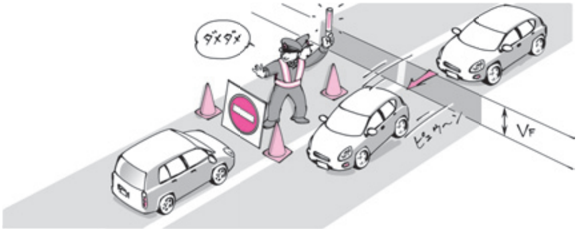
図1 ダイオードは一方通行！段差があって逆からは進めない
