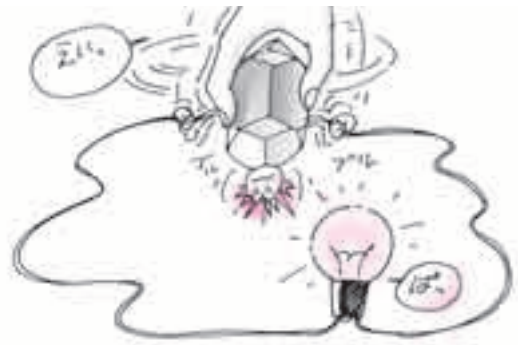
(b) ひずむと電圧が発生する
