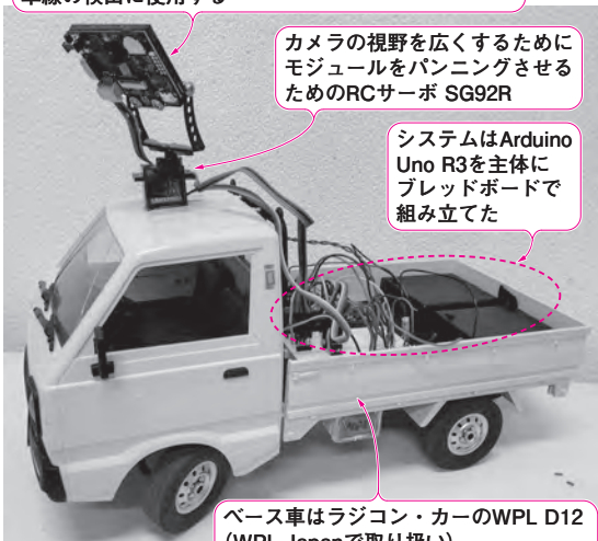
AI画像認識カメラ・モジュールHuskyLens (DFRobot) 車線の検出に使用する
