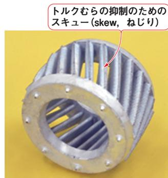
(b) アルミニウム鑄造によるかご(squirrel cage)形状のロータ
