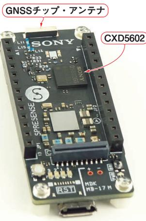
写真1 6000円ほどで入手できるフリスク・サイズの小型コンピュータSpresense(ソニー製)
