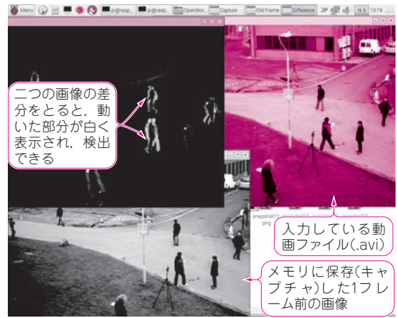
図2 動画の画像処理にトライ！動いた物体だけをくり抜いて表示できる(ラズベリー・パイにつないだHDMIディスプレイの画像)
