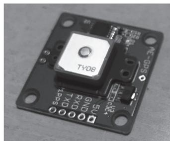
写真2 今回の製作には1 pps出力付き「みちびき」2機受信対応のGPS受信機キット(入手先: 秋月電子通商)を使用した
