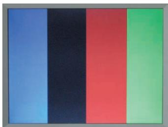
写真1 マイコン1個と簡単な外付け回路で作ったカラー・バー
