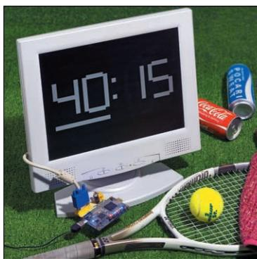
本章は、市販のマイコン・ボードを利用してパソコン・ディスプレイに画像を映し出すことを目的とします。ディスプレイへの接続には、ディスプレイに標準的に装備されているVGAコネクタを利用します。
