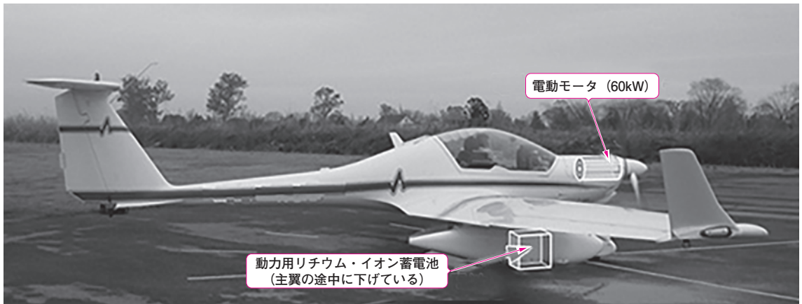
写真1 JAXAの電動航空機FEATHERパワエレ系をモデル化してみる エンジン付きグライダーを改造して電動航空機にした
