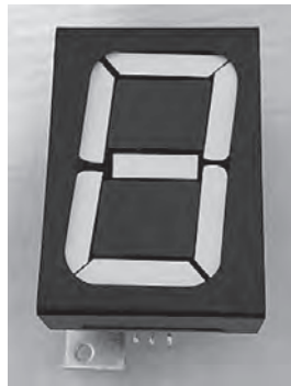
図1 磁気反転式表示器とその構造
