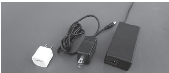
写真1 単電源でよければACアダプタが簡単 左: USBアダプタ(5V/1A), 中央: 汎用12Vアダプタ(12V/1A), 右: ノートパソコン用アダプタ(19V/3.42A)
