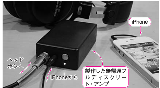
写真1 製作したひずみ0.003%以下の無帰還フルディスクリット・アンプ ゲイン1倍, カットオフ周波数11.5MHz, 出力インピーダンス0.5Ω
