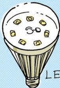
同じ明るさで光らせるための電流は、白熱電球よりも少なく、発熱が少ない
