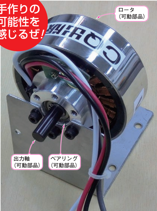
(a) EVの原動機はシンプル…モータ(DCブラシレス・モータ) 可動部がロータ、ベアリング、出力軸の三つしかない
