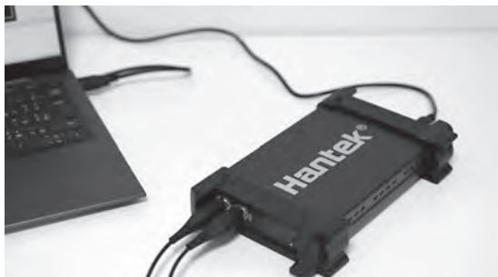
写真1 パソコンと接続するUSBオシロスコープ6022BE スペック等は第1部第1章にまとめてある
