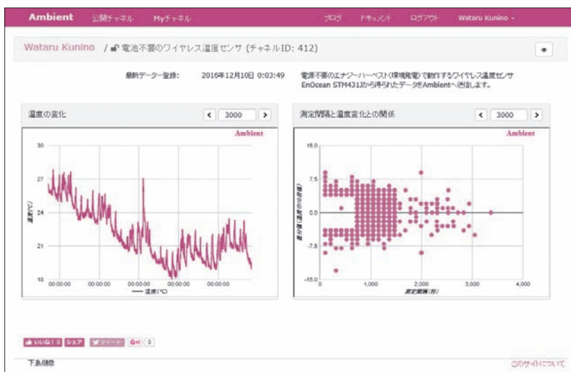
図1 EnOcean温度センサ送信モジュールSTM431Jを約1か月間動作させ続けたときの測定例。データの記録にはIoTセンサ用クラウド・サービスAmbientを利用
