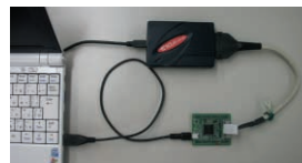
専用ハードウェア(有償)でデバッグしているようす
