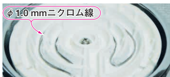
写真4 電熱線を抵抗率1.388 \Omega /m × 0.58mを2本並列のニクロム線に変えた電熱器
