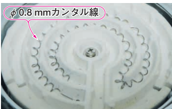
写真2 電熱線を抵抗率2.765 \Omega /m × 1mのカンタル線に変えた電熱器
