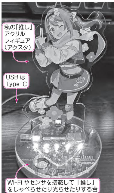
写真1 私の製作…USB Type-C対応IoTアクリルフィギュア台
