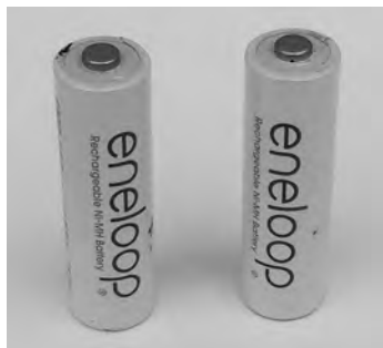
写真1 乾電池と同じ形状のニッケル水素電池 完全ではないものの、乾電池と互換性があることが一番の特徴
