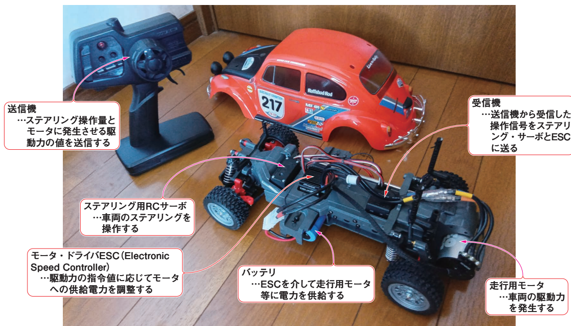
写真1 ラジコン・カーに搭載される電動ドライブ・システムの例
