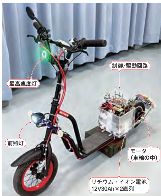
写真1 最大時速20km! 回生ブレーキ搭載の自作電動キックボード(スクータ)
