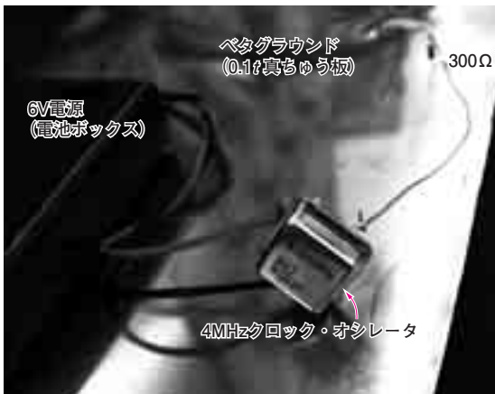
写真1 ベタグラウンド(図1)の正体を暴く実験のようす クロック・オシレータと300Ω抵抗と電池ボックス
