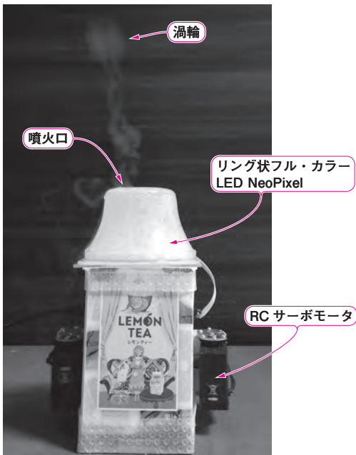
写真1 製作した超音波アトマイザ使用の大噴火ミスト・メーカー
