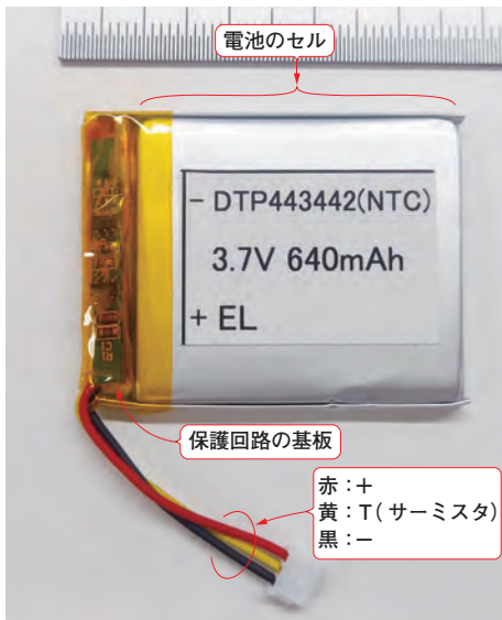
写真1 リチウム・イオン・ポリマ電池は薄くて軽い小型機器の組み込みに使われる。最低限の保護回路が付属しているタイプが入手しやすい。この例では温度測定用のサーミスタも内蔵する
