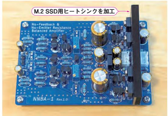
写真1 製作した入出力バランス・アンプの基板
