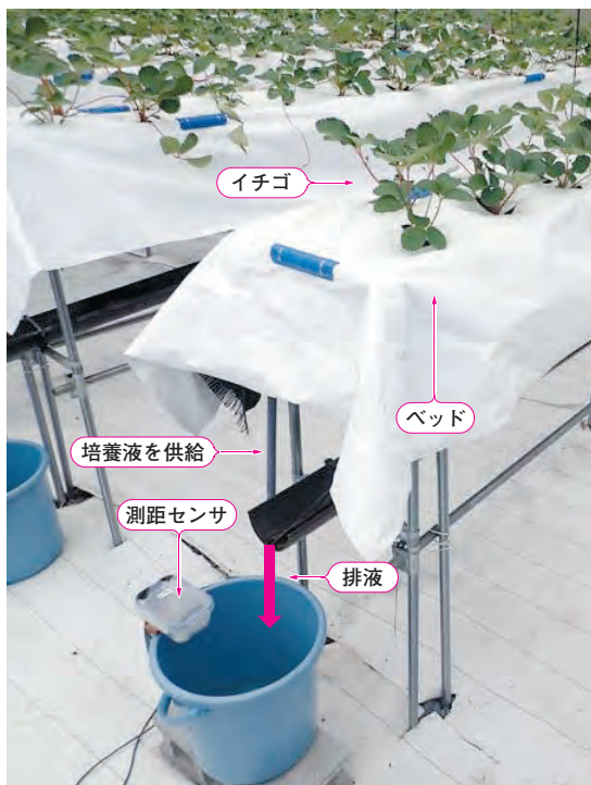
写真1 超音波測距センサを使ってイチゴ高設養液栽培の排水量計測に挑戦!
