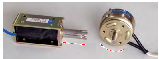
写真2 電磁石と鉄片を組み合わせて往復の動きを作る部品…ソレノイド
