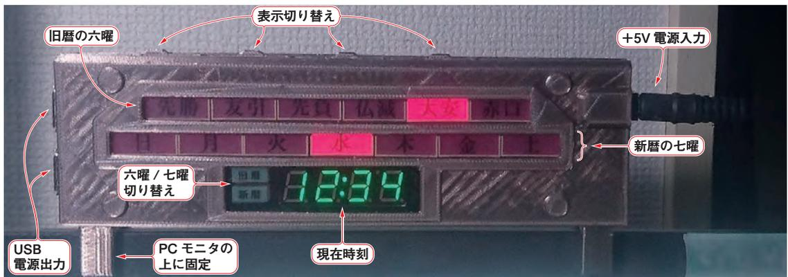
写真1 「大安」「仏滅」を計算で求めるデジタル六曜カレンダーを製作する…回路&プリント基板設計にはKiCad・ケース設計にはFreeCADという無償ツールをフル活用する
