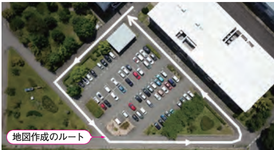
写真1 地図作成のルート…3Dカメラでこのルートの2次元地図データを作成する
