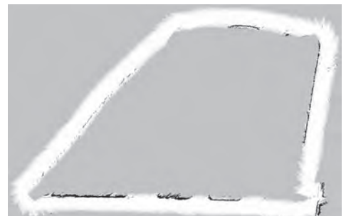
図2 rtabmap.dbから出力した2次元地図 (ROSナビゲーションに使用)
