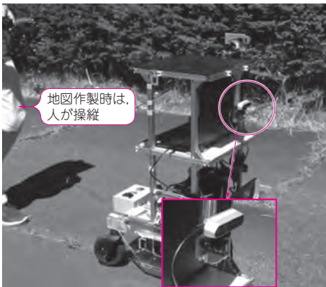
(a) D435iカメラを使って3次元画像取得
