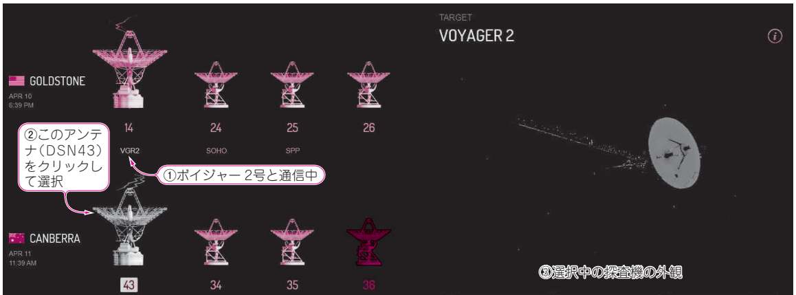
図2 Deep Space Networkの通信状態をモニタできるDSN NOW アメリカ、スペイン、オーストラリアの各拠点のパラボラ・アンテナ がどの探査機と通信しているのがひと目でわかる。通信中のビット・ レートや信号強度も表示される
