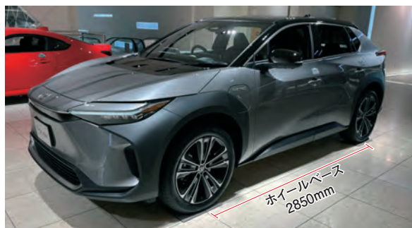
(b) bZ4X (トヨタ): 全長 4690 × 全幅 1860 × 全高 1650 [mm]
