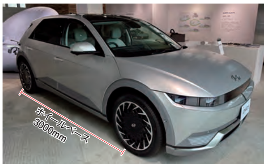
(a) IONIQ 5 (ヒョンデ): 全長 4635 × 全幅 1890 × 全高 1645 [mm]
