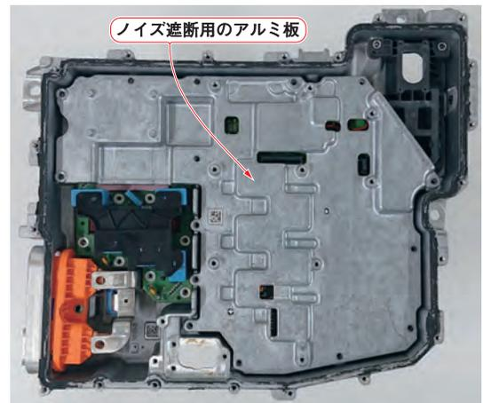
(b) 制御基板を取り外したようす
