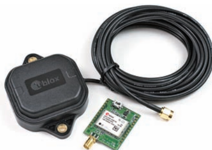
写真1 cm精度の自己位置推定ができるGNSS受信モジュール「トラ技2周波RTKスタータ・キット」
