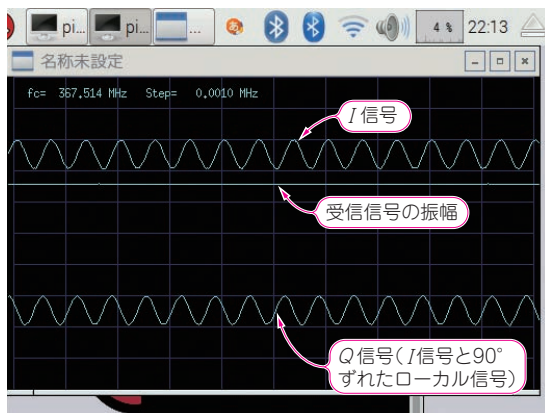
図3 高周波の波形を見ることが出来る この波形を元に信号処理で振幅や位相を求めていくと、電波に乗せてある情報を取り出せる。それを「復調」という
