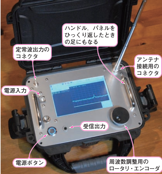
写真1 電波をソフトウェアで解説するポータブル受信機Piラジオ 受信周波数 50 M~2 GHz, 受信帯域幅 30 MHz, 感度 -120 dBm(狭帯域FM受信)
